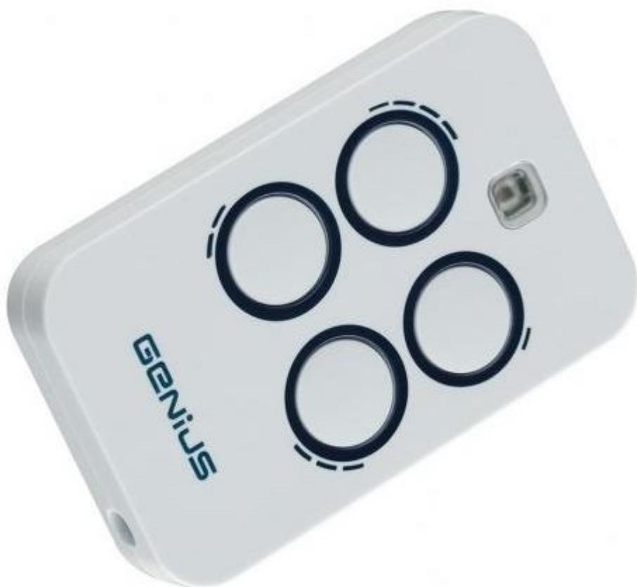
Série AMIGO je patentovaný rádiem řízený 868 MHz systém s plovoucím kódem. Při každém přenosu se přenášený kód mění podle souboru algoritmů, synchronizovaných s údaji, které přijímač očekává.
