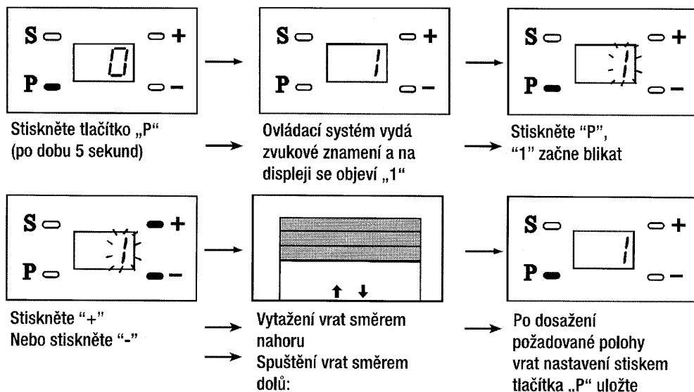
**⚠️ Varování:** je nutné nejprve nastavit doraz pro otevřenou polohu vrat a teprve poté doraz pro zavřenou polohu.
