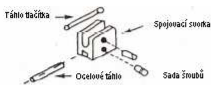
Obrázek 3: MONTÁŽ TÁHEL KE SPOJOVACÍ SVORCE
